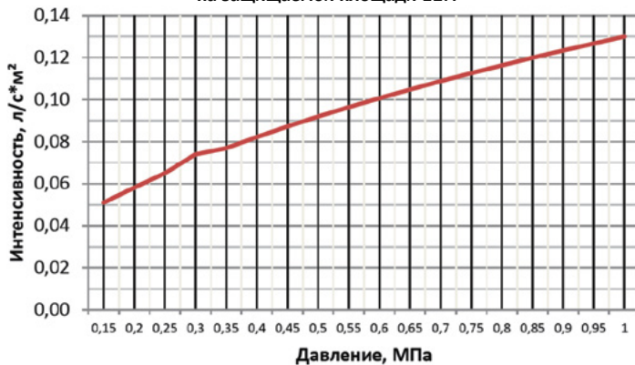
График зависимости интенсивности орошения от давления при применении пенных растворов с коэффициентом производительности K = 0,3 на защищаемой площади 12\text{ м}^2
